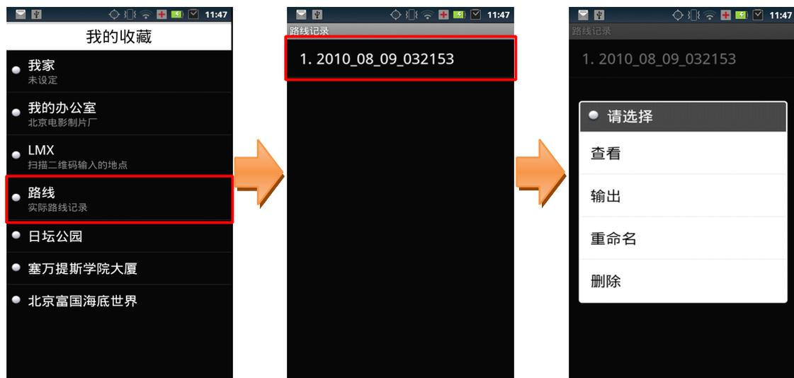
**提示：**“路线”中保存的轨迹是由实际 GPS 定位点连接而成，通过客观、连续的 GPS 定位点表示用户的出行路线。由于 GPS 定位误差的存在，所记录轨迹与实际路线会存在一定偏差。
